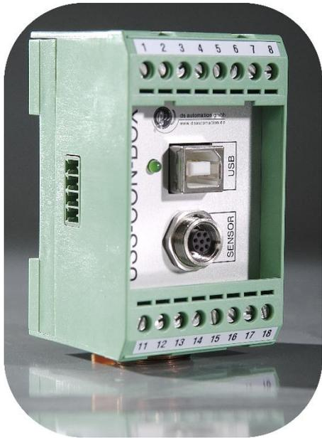
Verbindungsbox im Tragschienengehäuse für den Anschluss der dsound® USS4-Sensoren mit 16 Schraubklemmenanschlüssen für Versorgung und Sensor-I/O
